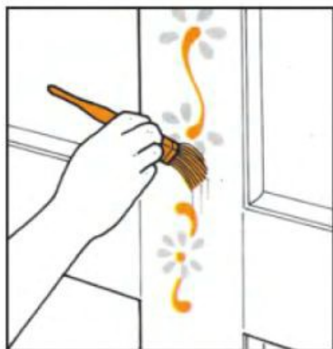
Узоры, нанесённые на подверженные интенсивному износу деревянные поверхности, покрывают защитным прозрачным лаком.
