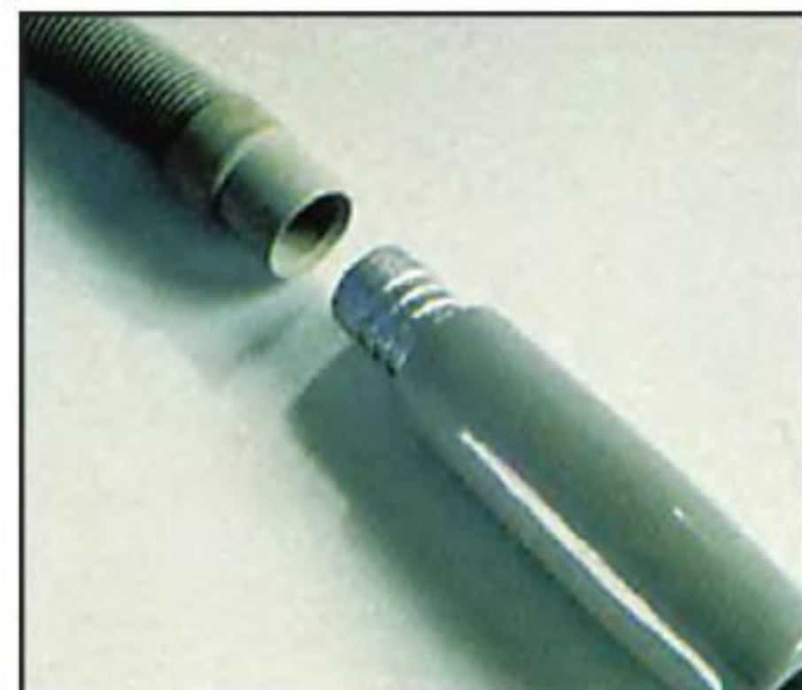
Простой, но достаточно надёжный способ удержания шланга на краю ванны — закрепить отрезок трубы на конце сливного шланга.
