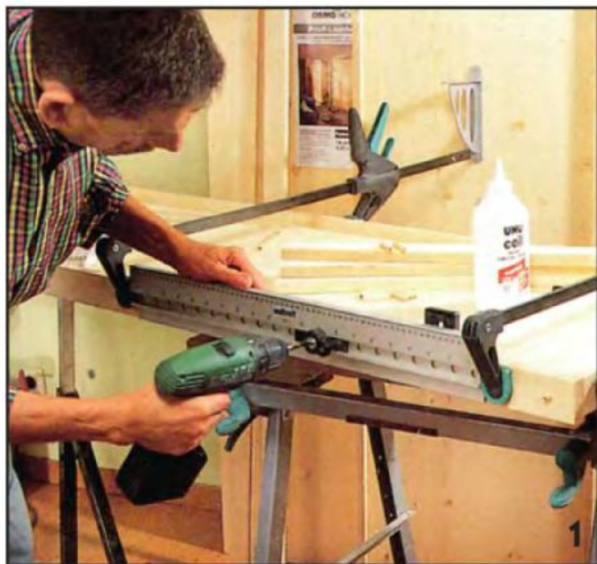
Створки вешалки собирают из мебельных щитов и деревянных брусков, соединяя их друг с другом на шкантах.
