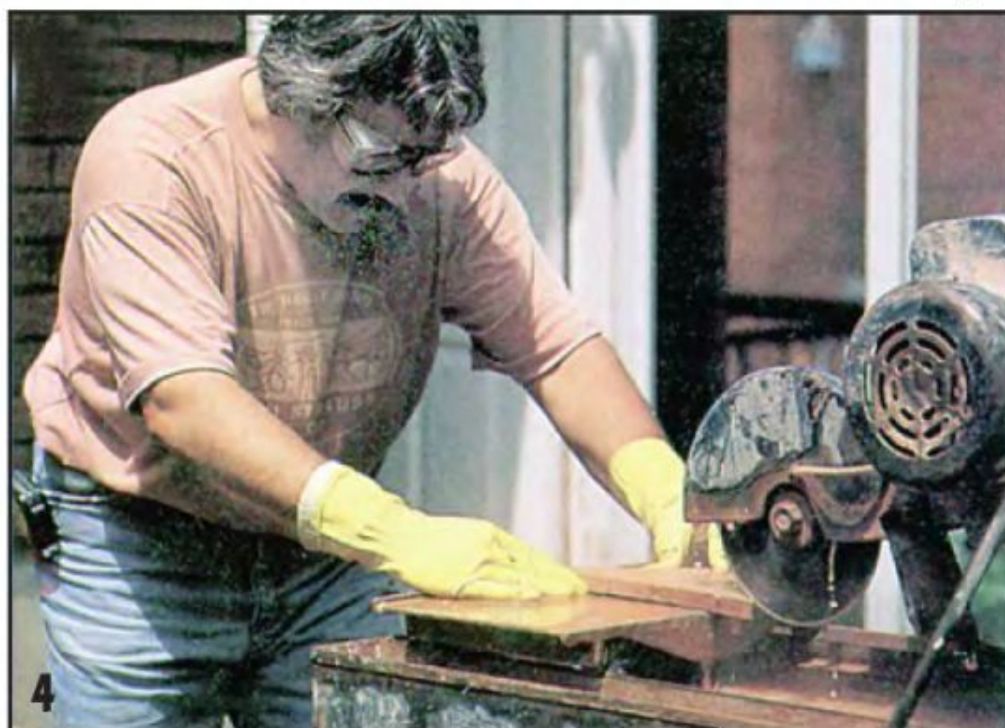
Работать с дисковой пилой нужно в защитных очках и перчатках. Плитку под диск подают только с помощью штатного подвижного стола пилы.
