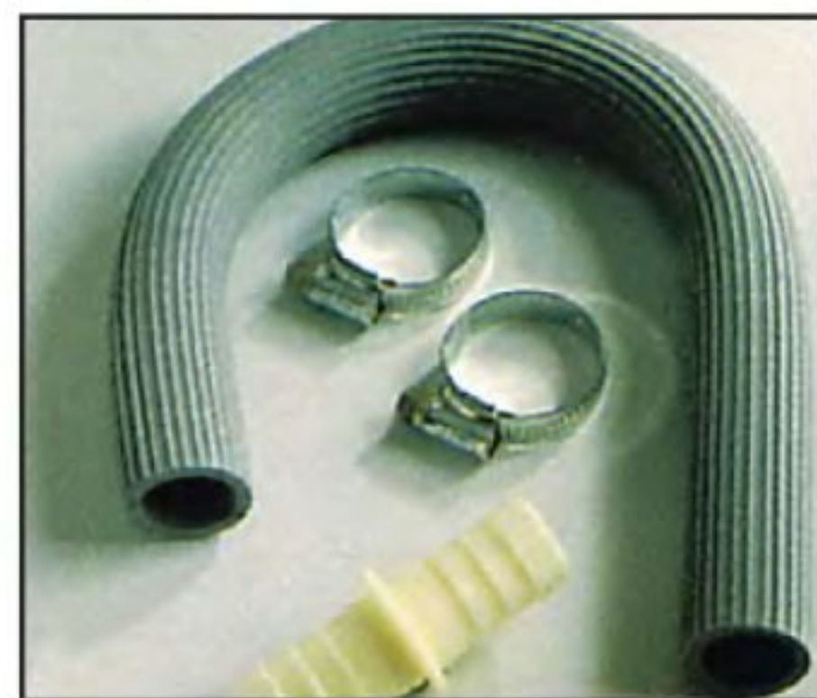
Чтобы повесить шланг на край ванны, его удлиняют специальным загнутым коленом (если его нет на штатном шланге) с помощью двойного штуцера и хомутов.
