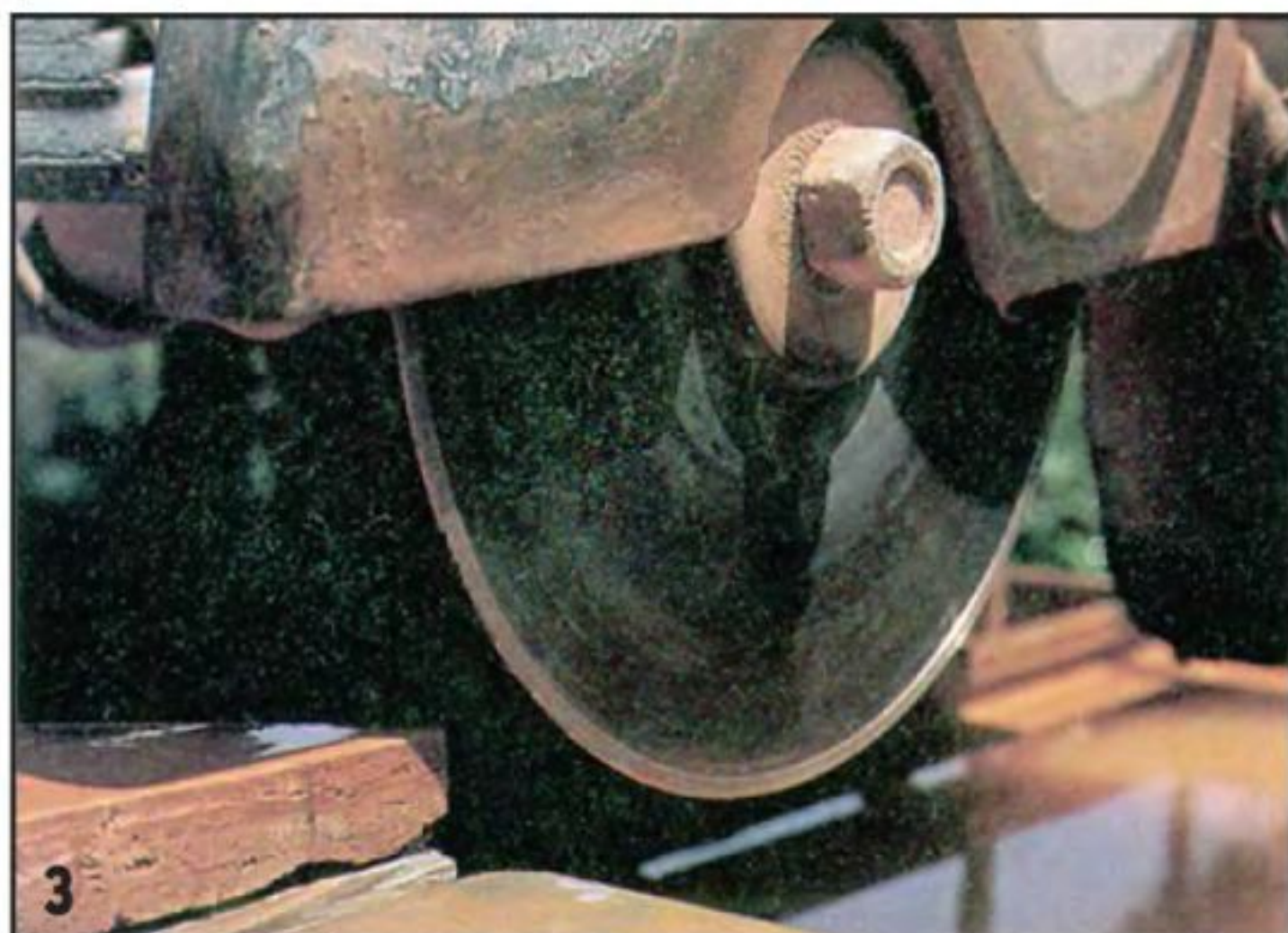
Алмазная дисковая пила — хороший помощник при раскрое плитки. Мощная струя воды не только охлаждает пильный диск, но и уносит образующуюся пыль, которой бывает очень много.
