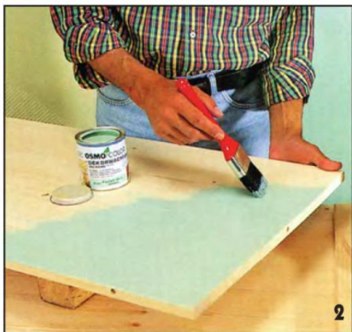
Выкроенные в размер мебельные щиты лучше окрасить ещё до сборки створок, иначе кистью можно случайно задеть обрамляющие бруски.
