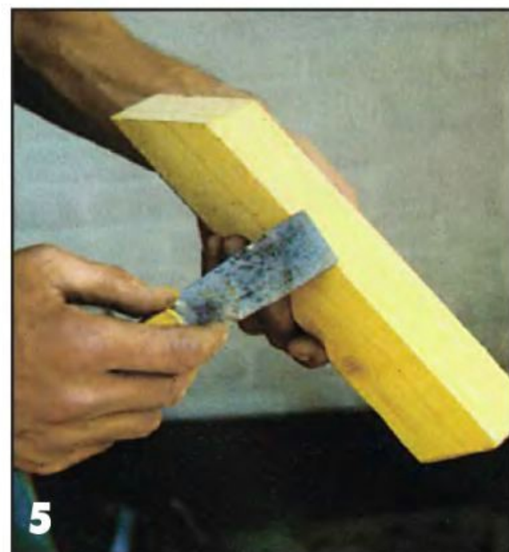
5 Прозрачный как стекло двухкомпонентный клей наносят шпателем на все контактирующие поверхности.
